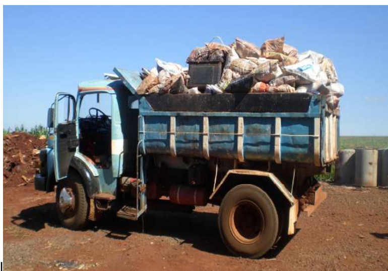
Figura 31: Caminhão com divisória na caçamba para coleta de lixo orgânico e reciclável
